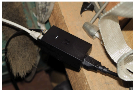
(h) L'antenne est alimentée électriquement à l'aide d'un injecteur PoE.
