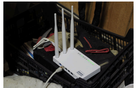
(i) Routeur/borne wifi (configuré en bridge) offert par Tetaneutral.net, permettant de recevoir directement des IP du château. Le réseau wifi porte directement le nom de la compagnie de cirque et permet aux caravanes à proximité de se connecter à Internet.
