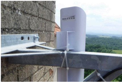
(a) Une antenne NanoStation M5 qui pointe vers le hangar rouge a été ajoutée sur le mât de l'antenne du WAN. Elle permet d'agrandir le LAN jusqu'aux caravanes du cirque qui sont stationnées sur un terrain du château.
