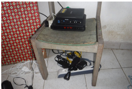
(a) Matériel chez l'habitant : le Shuttle (passerelle VPN) est posé sur la Livebox. Il est connecté à la fois à la Livebox et à la LiteBeam (antenne directionnelle) à l'extérieur.
