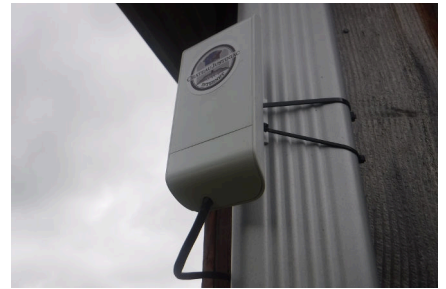
(c) L'antenne utilisée pour la réception est une NanoStation Loco M5, positionnée sur le hangar rouge.
