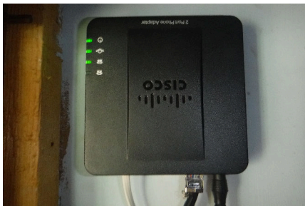
(a) Routeur VoIP Cisco SPA112 préconfiguré par OVH, permettant de relier n'importe quel téléphone analogique au compte VoIP OVH.
