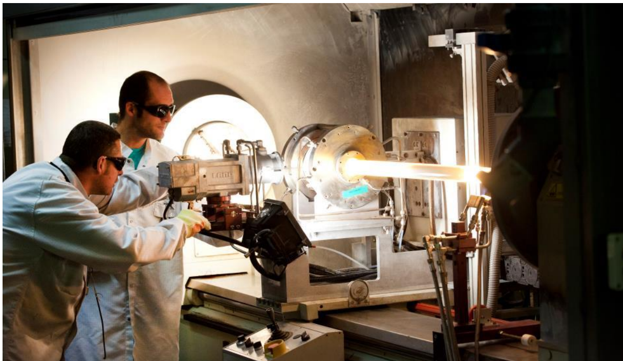
Photo : Production de préforme de fibres : dépôt interne
