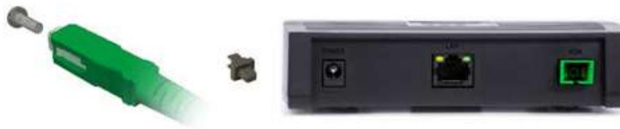
2. Insérez l'embout de la fibre optique, dans le port PON jusqu'à entendre un "clic" de verrouillage. Assurez-vous que l'embout soit bien bloqué.
