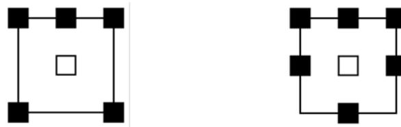
Figure 8 : Disposition des enceintes en 5.1 (à gauche) et en 6.1 (à droite)
