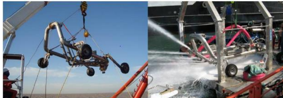
Un trencher de type « jet sledge »
