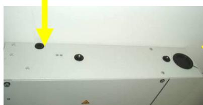
Vérifier que les passes câbles soient bien en place sur le module supérieur
