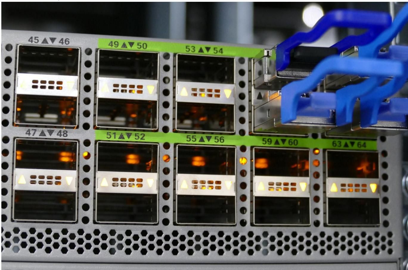
Ces switches haut de gamme intègrent chacun 32 Go de RAM et un SSD de 256 Go. La table des adresses MAC gère 92 000 entrées. Deux alimentations de 1200 watts permettent d'alimenter le switch avec une redondance en cas de perte d'une alimentation. Le connecteur d'alimentation est différent de connecteurs habituels, car on peut dépasser les 10 ampères en 110 volts. La consommation typique donné par la documentation constructeur est de 429 watts.
