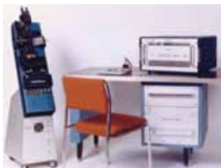
TACITE : Testeur Automatique de Circuits Intégrés ... (Manu et Bodin se souviennent du reste).
