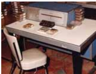
TREGOR : Testeur de RElais ... Rampe (Manu et Bodin se souviennent du reste). Initialement développé pour tester les relais équipant les cartes du CSA
