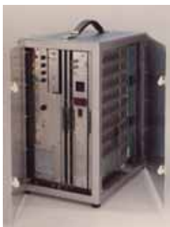
ARMEN : testeur de cartes mémoire de l'OCB181 (MSKM) (version chantier)
