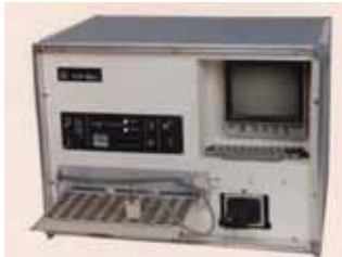
TLP : Testeur Logique Portable. Testeur de cartes logiques ; TLP est une version en coffret du testeur ORACLE (Organe Réalisant Automatiquement le Contrôle Logique des Equipements). Les programmes de test pouvaient être élaborés par un générateur automatique de séquences de test (LOGITEST) développé au CNET ou par un programme exécuté sur le PDP11 intégré dans la machine
