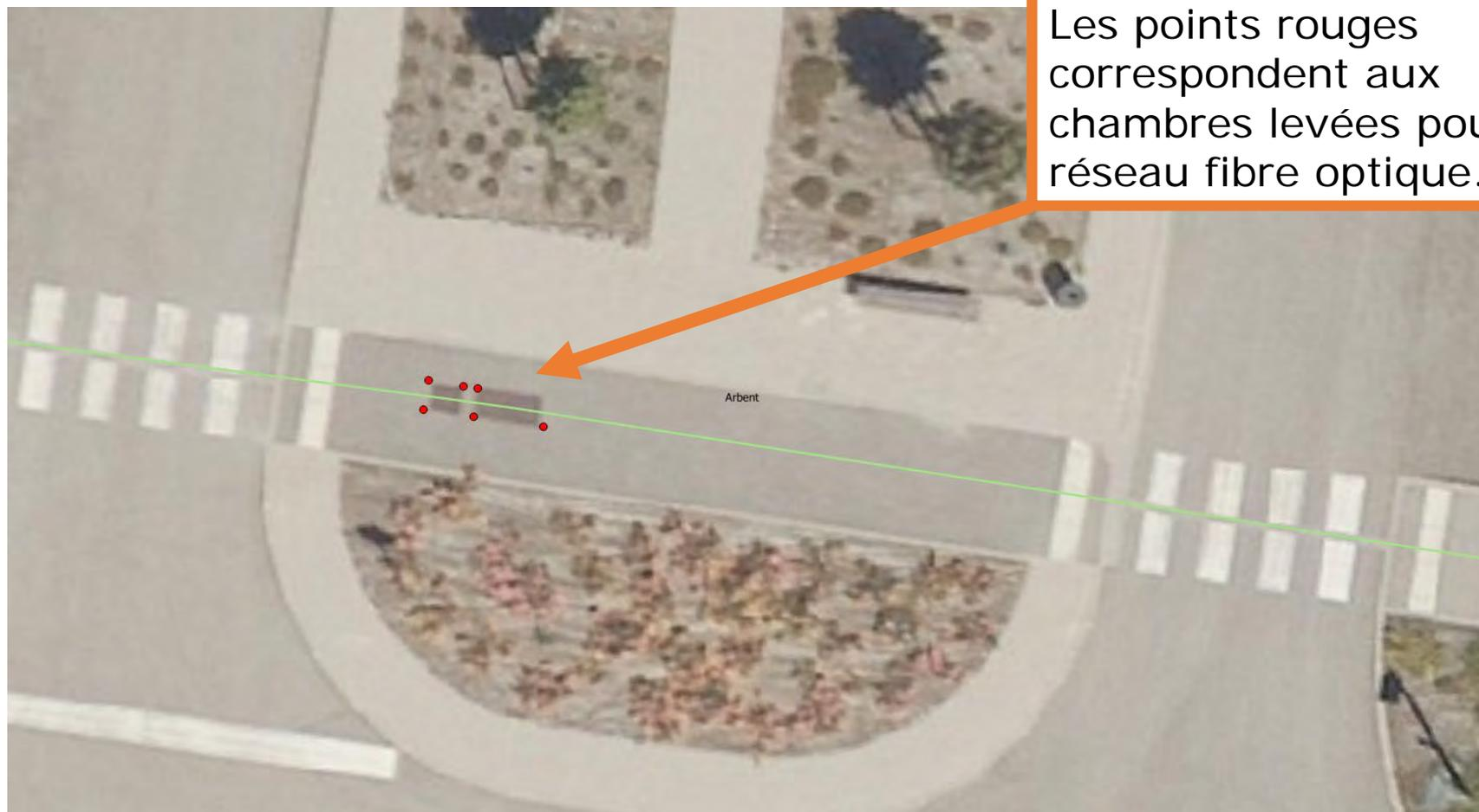
Les points rouges correspondent aux chambres levées pour le réseau fibre optique.
