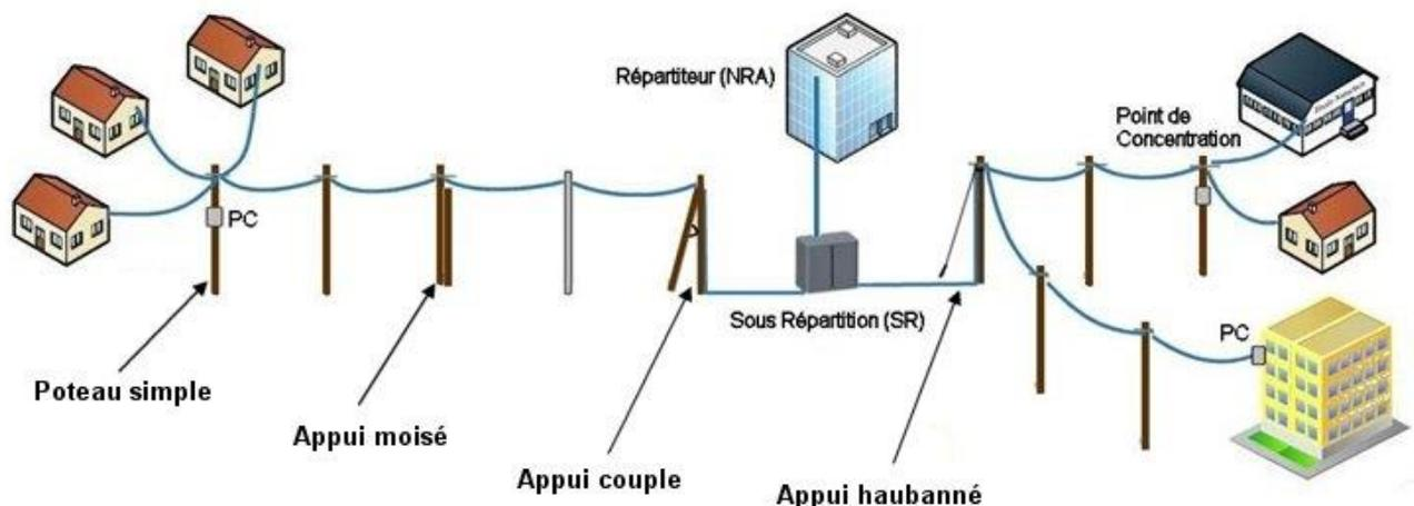
La distance moyenne entre deux poteaux consécutifs est d'environ 35 mètres. Chaque poteau sur le terrain fait l'objet d'un étiquetage de couleur bleue comportant un numéro d'identification.
