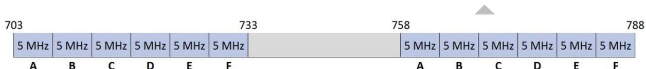
Figure 1 : Schéma des blocs de fréquences objet de la procédure
