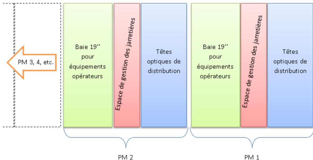
Dans cette configuration, il n'est pas possible de réaliser un brassage depuis les têtes de distribution d'un PM donné vers la baie opérateur d'un autre PM. Un opérateur commercial devra installer des équipements dans chaque PM pour avoir accès à l'ensemble des lignes FttH. On parle donc bien de PM distincts. Chaque PM devra avoir une zone arrière continue et conforme à la réglementation.
