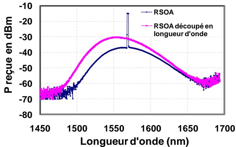
Figure 4—51 : Spectre du RSOA après Spectrum Slicing
