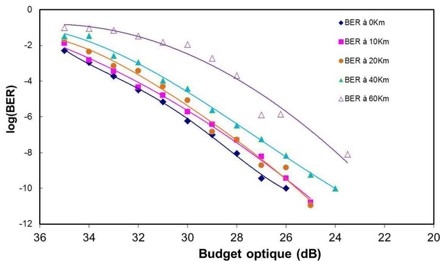
Figure 4—87 : BER à 5 Gbit/s en fonction du Budget optique
