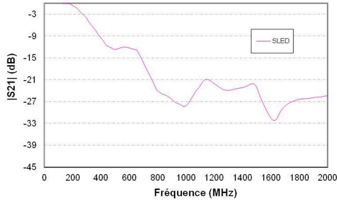
Figure 4—41 : Bande passante électrique de la SLED
