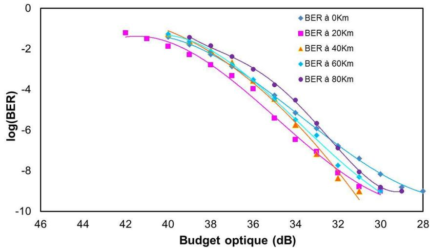
Figure 4—86 : BER à 2,5 Gbit/s en fonction du Budget optique
