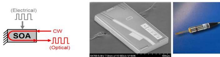
Figure 3—28 : Principe de fonctionnement d'un RSOA , exemple de sa structure et composant packagé réalisé par CIP [Sm51].
