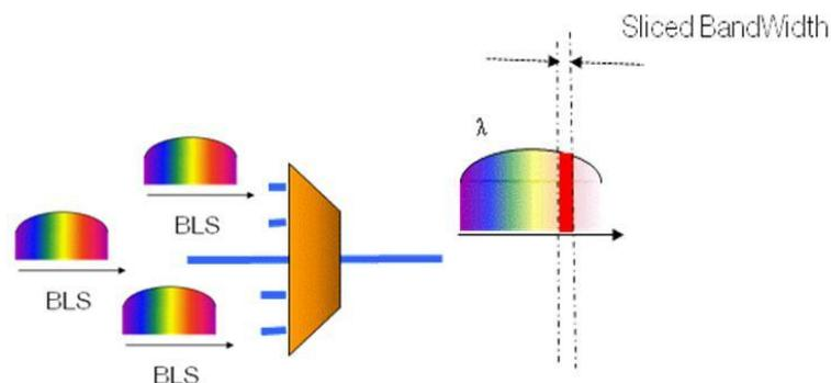
Figure 4—38 : Principe de la technique « Spectrum Slicing » d'une source large bande
