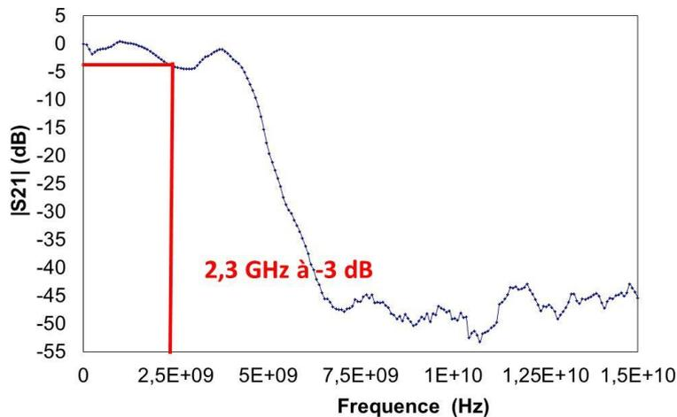
Figure 4—96 : Bande Passante du récepteur accordable
