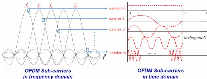
Figure 2—13 : Principe du multiplexage par porteuses du type OFDM
