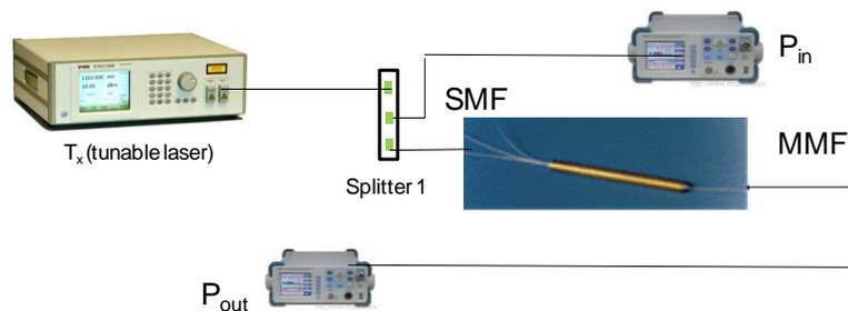
Figure 4—10 : Montage expérimental pour les mesures des pertes d'insertion du Combineur 4 vers 1
