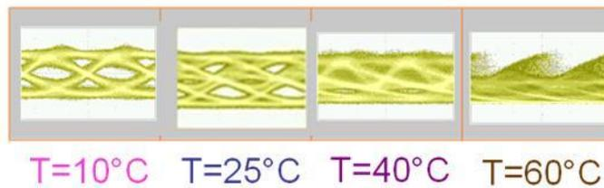
On remarque que pour une température comprise entre 10°C et 40°C, l'œil reste ouvert. Les mesures de BER en fonction du budget pour différentes températures lorsque l'égaliseur est inséré sont présentées dans la Figure 4-36 suivante.
