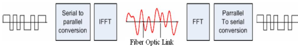
Figure 2—17: Schéma du principe de transmission OFDM
