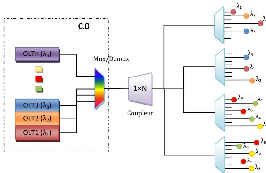
Figure 2—32 : Réseau d'accès flexible base sur un coupleur passif (sens descendant)
