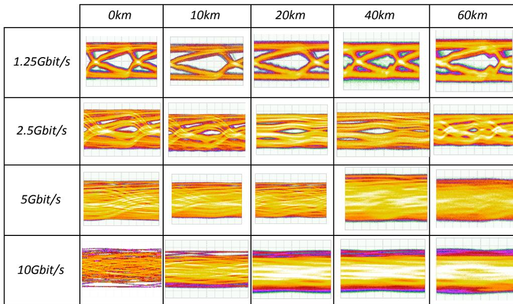
L'œil se ferme complètement pour les plus grandes distances de fibre car le signal souffre de la dispersion chromatique. Par exemple, à 2,5 Gbit/s l'œil se ferme à partir de 20 km. De même, on note qu'un débit élevé dégrade la qualité du signal reçu à l'APD (sans égaliseur) à 5 Gbit/s et 10 Gbit/s. Cette mauvaise qualité de transmission est causée par la faible bande passante de 400 MHz du laser accordable (T-ECL).
