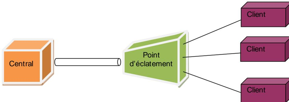
Figure 1—2 : Terminologie du Réseau d'Accès
