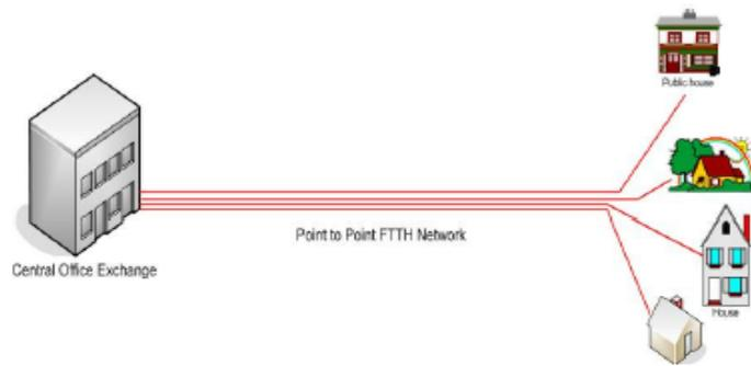
Figure 1—4 : Topologie Point à Point (P2P)
