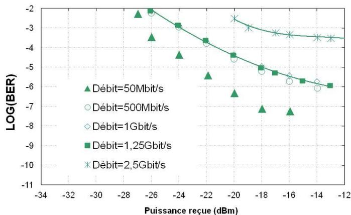
Figure 4—62 : BER vs Puissance reçue en fonction du débit pour un budget optique de 16,2 dB ( L=0 km)
