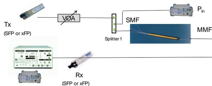
Figure 4—12 : Montage expérimental pour les mesures de BER dans une transmission avec le Combineur 4 : 1
