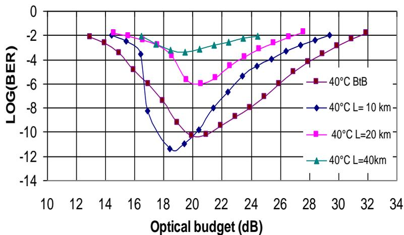
Figure 4—32 : Courbe de BER vs. Budget pour différentes longueurs de fibre (T=40°C et avec égaliseur)
