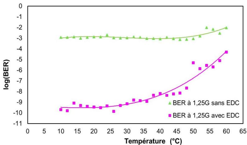
Figure 4—82 : Courbes de BER en fonction de la Température de la SLED sans ou avec égaliseur pour un budget de 35 dB
