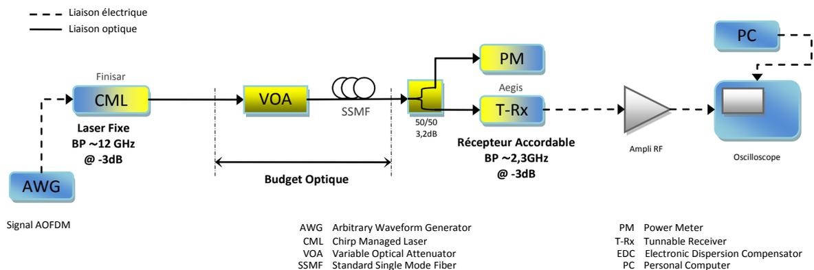
Figure 4—99 : PON Agile en longueur d'onde intégrant un T-Rx et avec un format de modulation OFDM
