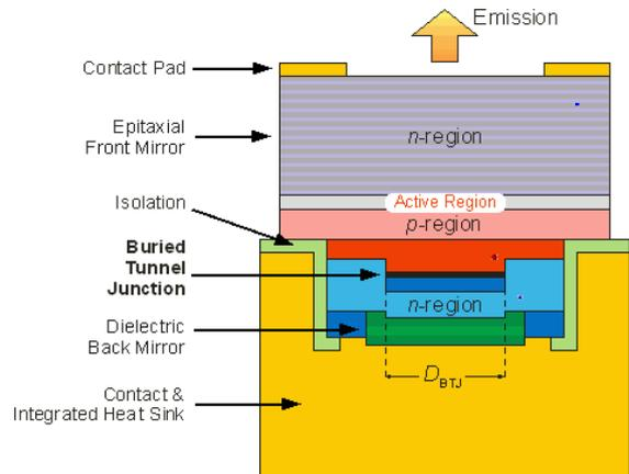
Figure 3—20 : Diode laser à cavité verticale (VCSEL)
