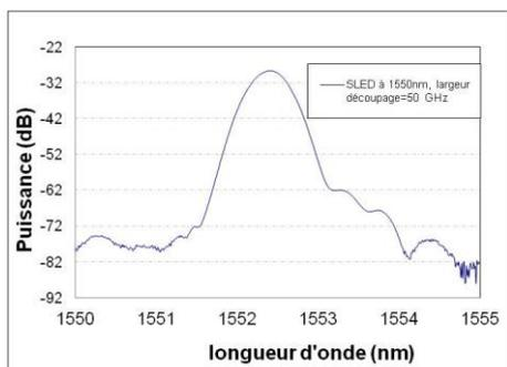
Figure 4—45 : Spectre obtenu après découpage à 50 GHz
