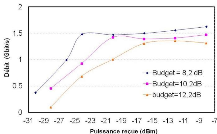
Figure 4—67 : Débit vs Puissance reçue pour différents budgets optiques avec L=20 km
