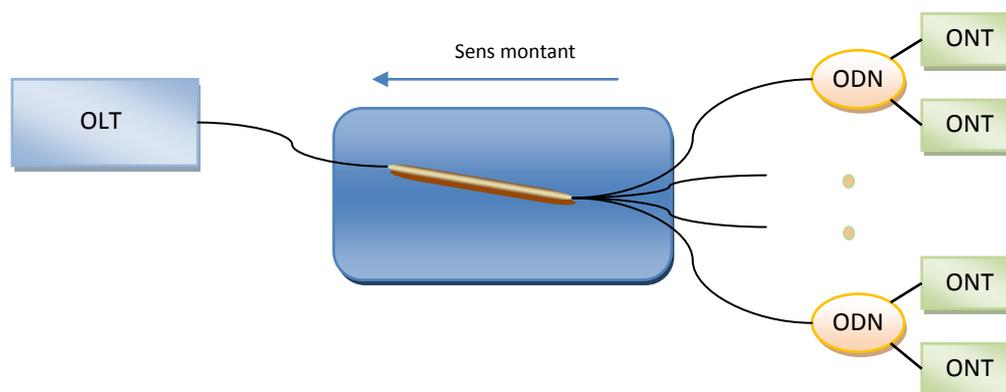
Figure 4—4 : Solution passive pour la longue portée intégrant un Coupleur passif 1 vers 4
