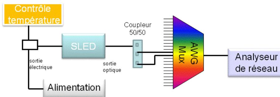
Figure 4—44 : Technique implémentée pour la réalisation d'un découpage spectral de 150GHz à -3dB
