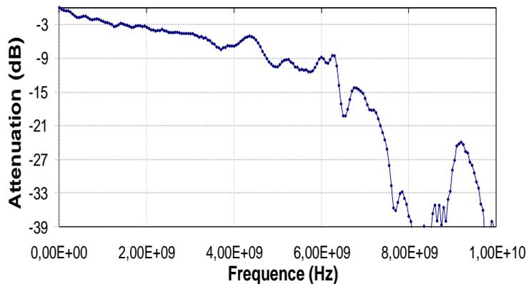
Figure 4—26 : Bande passante électro-optique du laser DFB
