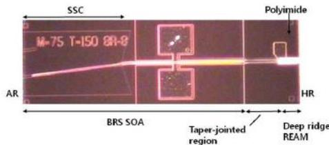
Figure 5—4 : Photographie de la puce SOA-REAM pour les transmissions à 10 Gbit/s développée par ETRI
