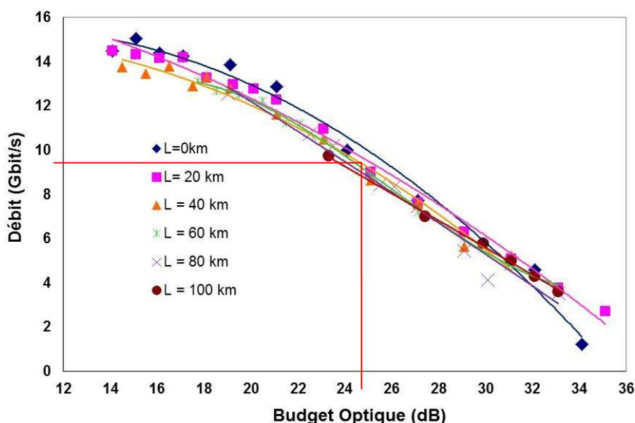
Figure 4—100 : Débit en fonction du Budget en modulation OFDM
