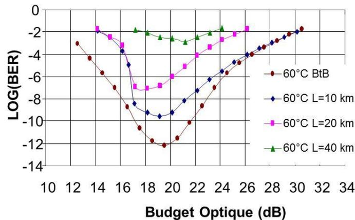
Figure 4—33 : Courbe de BER vs. Budget pour différentes longueurs de fibre (T=60°C et avec égaliseur)
