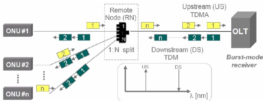
Figure 2—1 : Architecture PON basée sur le multiplexage temporel (TDM)
