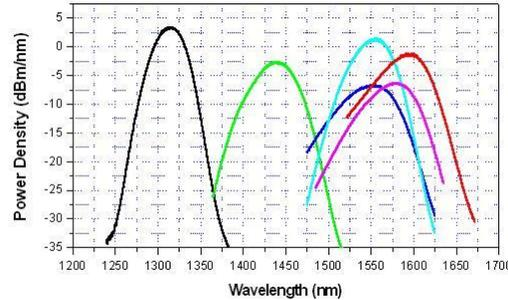
Figure 3—13 : SLED offrant une plage spectrale large entre 1260 nm et 1640 nm
