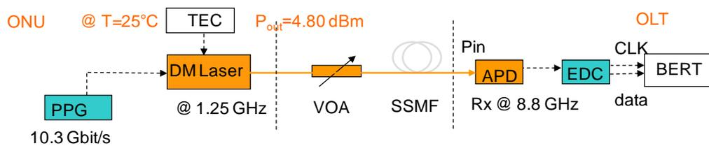
Figure 4—30 : Montage expérimental avec un laser DML à 1GHz et intégrant l'égaliseur (ou EDC) pour une application longue portée
