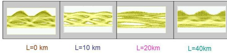
On observe une dégradation de l'œil qui indique que le signal reçu est altéré. Toutefois les mesures de performances en transmission lorsque le système est assisté par EDC vont révéler de meilleurs résultats. La Figure 4-33 nous révèle les courbes de BER mesurées à partir du testeur de BER (ou BERT) à 60°C.
