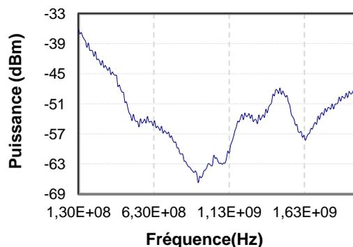
Figure 4—47 : Bande passante du SLED après découpage spectral à 150 GHz
