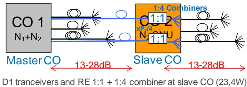
Figure 4—24 : Scénario de consolidation avec un transpondeur B+ , un RE 1 : 1 et le combineur 4 vers 1
