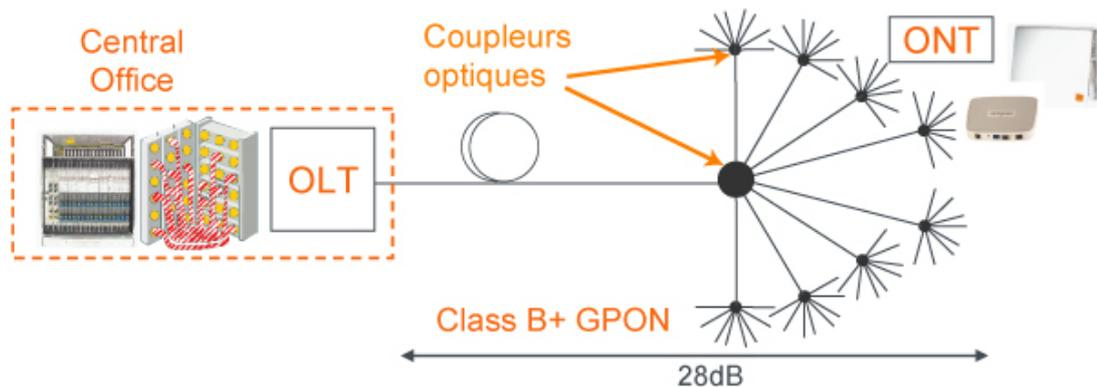
Figure 1—7 : Schéma du GPON
