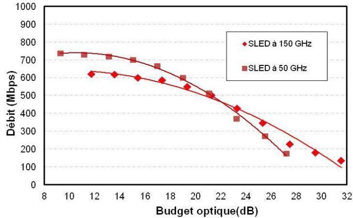
Figure 4—49 : Débit vs Budget avec découpage spectral à 50 GHz et 150GHz
