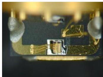
Figure 3—1 : Laser à modulation directe
