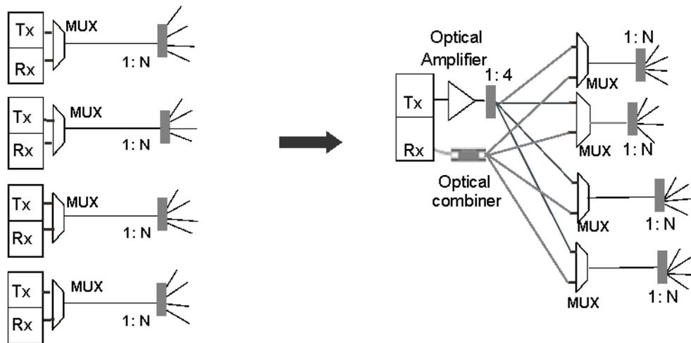
Figure 4—18 : Schéma de l'évolution de l'agrégation physique de l'OLT GPON
