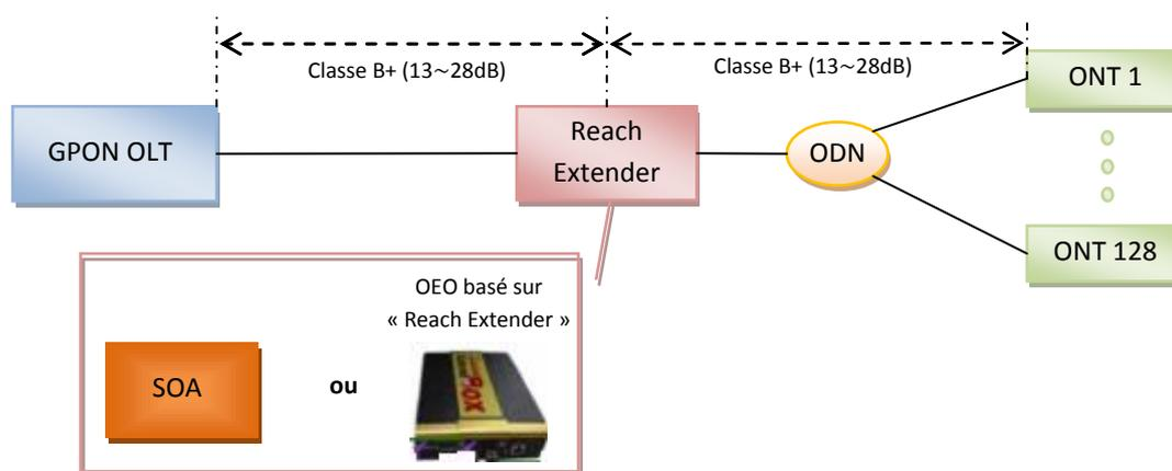
Figure 4—2 : Principe du G-PON à longue portée avec Extender Box
