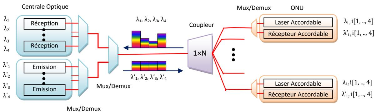
Figure 4—70 : Architecture du PON Agile en longueur d'onde proposée
