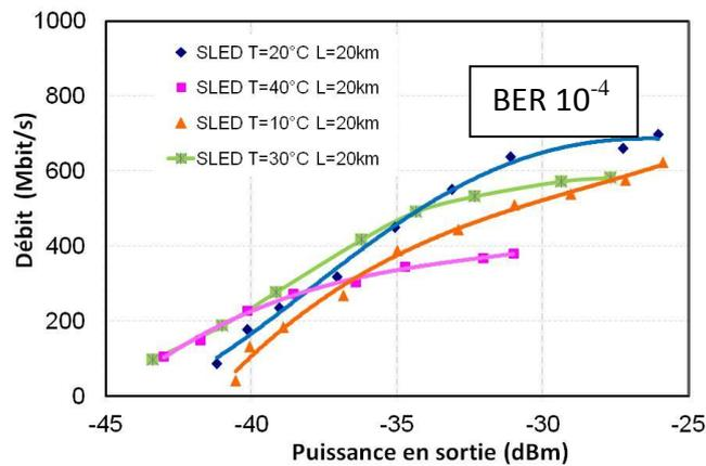
Figure 4—43 : Débit vs. Puissance reçue à l'APD pour différentes températures (T[10°C-40°C])
