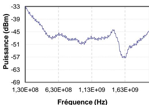
Figure 4—48 : Bande passante du SLED après découpage spectral à 50GHz
