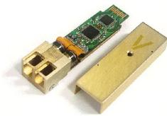
Figure 3—10 : Transducteur de type SFP
