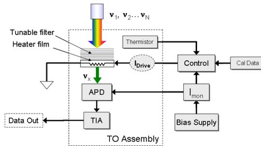
Figure 4—75 : Diagramme fonctionnel du récepteur accordable d'Aegis
