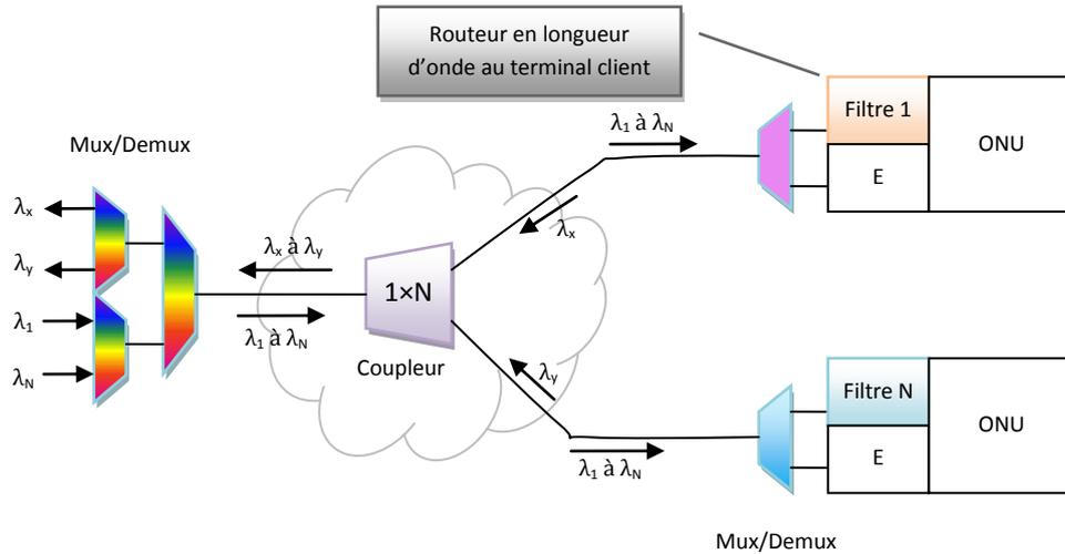
Figure 4—69 : Principe du WDM-TDM PON : lorsque le routage en longueur d'onde s'effectue à l'extrémité du réseau d'accès du côté de l'ONU
