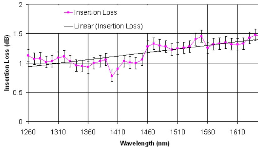
Figure 4—11 : Pertes d'insertion du combineur 4 vers 1 en transmission
