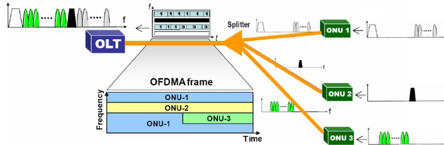
Figure 2—14 : Schéma de principe de l'OFDMA-PON
