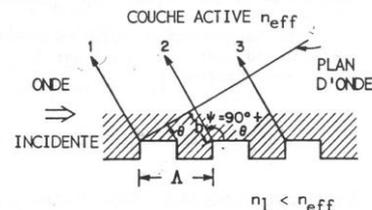
Figure 3—2 : Contre-réaction sur réseau de Bragg du DFB
