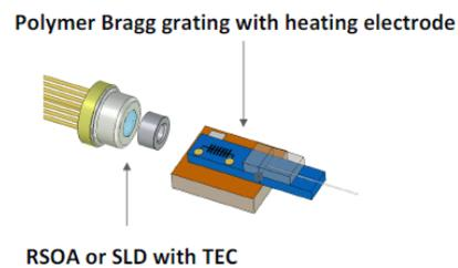
Figure 3—22 : Laser à cavité externe compatible avec un débit de 2,5 Gbit/s
