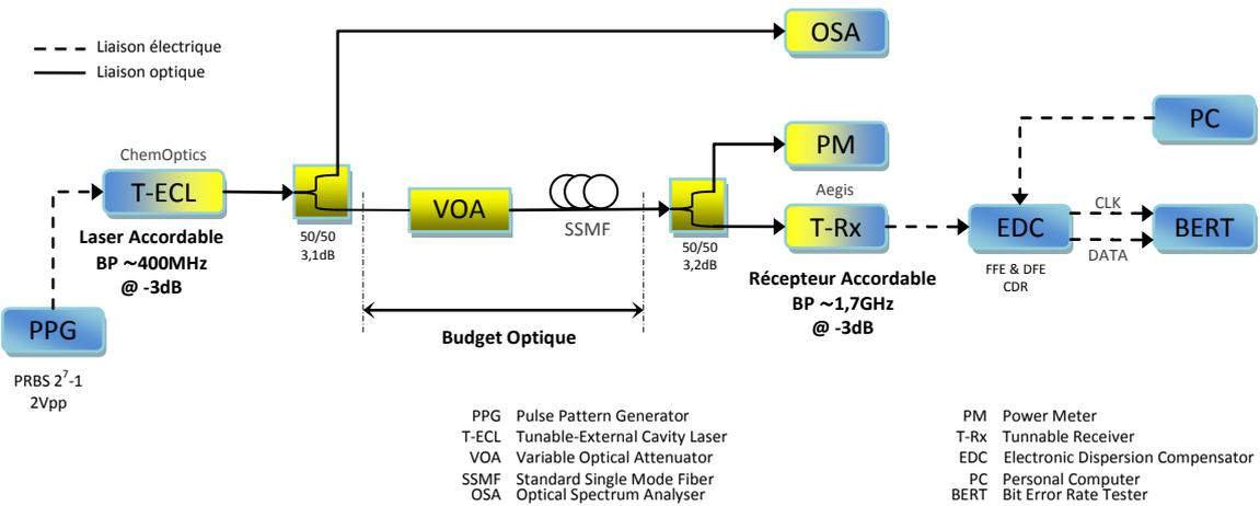
Figure 4—89 : Montage expérimental du PON Agile intégrant un T-ECL (à l'OLT) et T-Rx (à l'ONU) assistés par égaliseur
