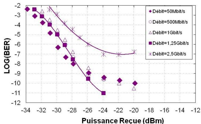
Figure 4—60 : BER vs Puissance reçue en fonction du débit pour un budget optique de 8,2 dB ( L=0 km)
