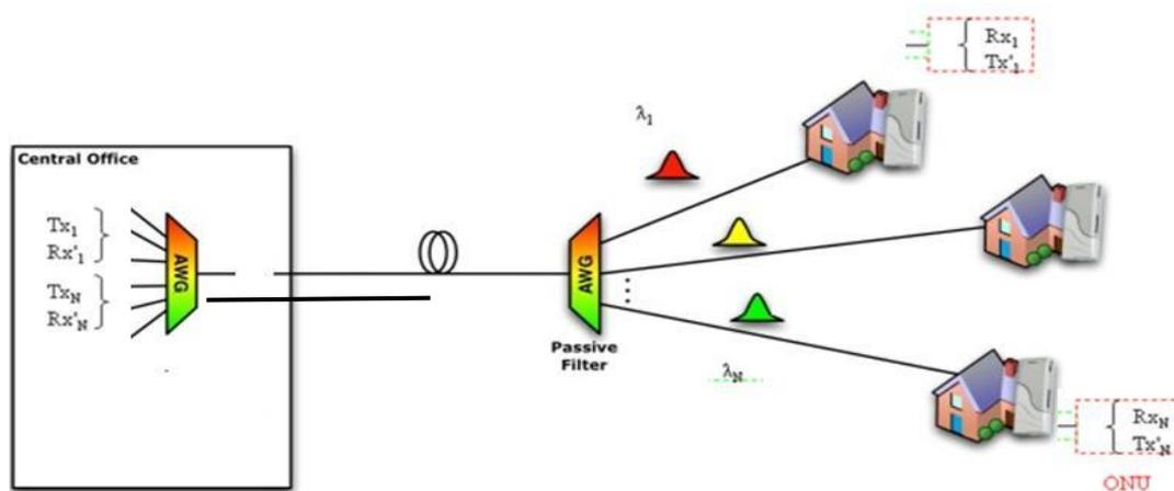
Figure 4—37 : Principe de base du pur WDM PON
