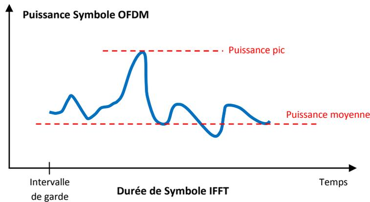
Figure 2—21 : Rapport puissance crête-puissance moyenne (PAPR) OFDM dans un intervalle de symbole
