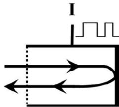
Figure 3—15 : Principe de fonctionnement et caractéristiques simplifiées du RSOA
