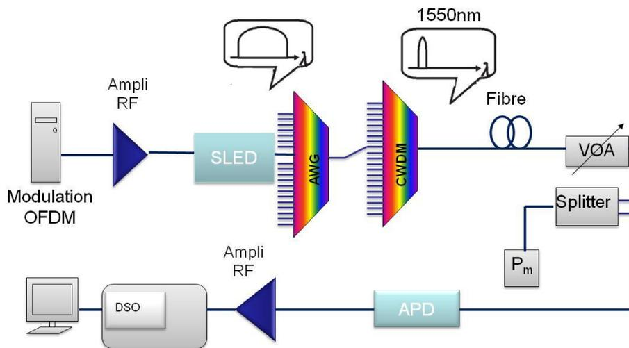
Figure 4—40 : Montage expérimental d'un WDM PON simplifié avec une SLED comme source large bande
