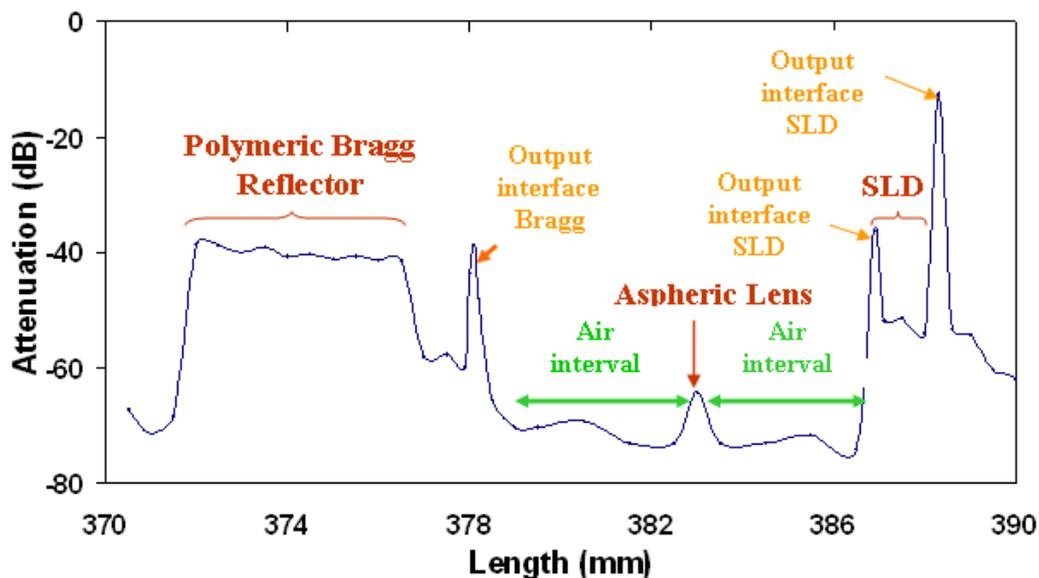
Figure 4—72: Mesure OTDR de l'assemblage Laser accordable à 1546 nm
