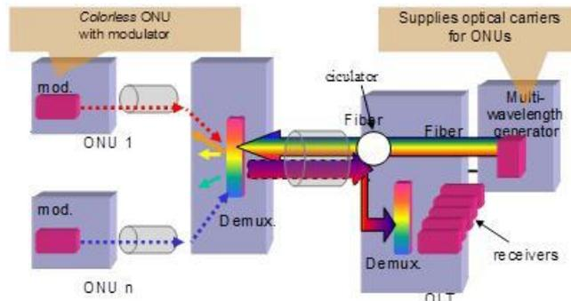
Figure 3—24: Architecture avec modules de distributions de porteuses continues au central et modules réfléchifs à l'ONU pour les signaux montants
