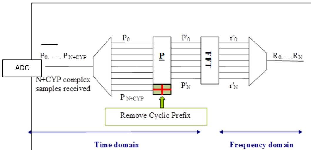
Figure 2—16 : Démodulation OFDM
