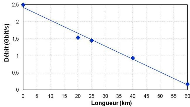
Figure 4—68 : Débit en fonction de la longueur d'onde avec un format de modulation OFDM
