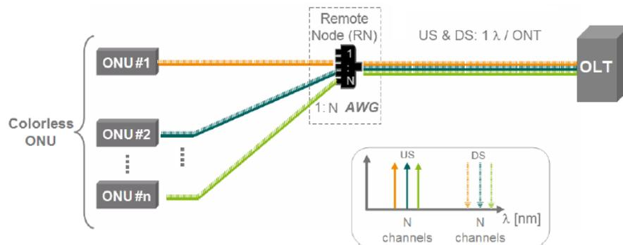
Figure 2—2 : Architecture PON base sur le multiplexage en longueur d'onde WDM
