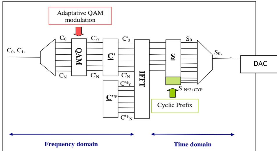
Figure 2—19 : Modulation AMOOFDM en bande de base.
