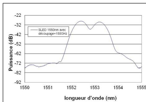
Figure 4—46 : Spectre obtenu après découpage à 150 GHz
