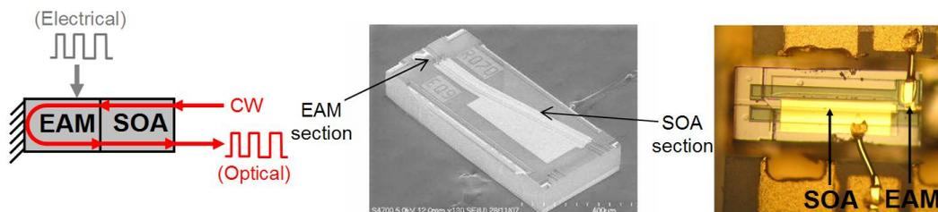
Figure 3—29 : Principe de fonctionnement d'un R-EAM-SOA et un exemple de sa structure réalisé par CIP [Sm51] et de celle réalisée par Alcatel-Thales III-V dans le cadre du projet ANTARES
