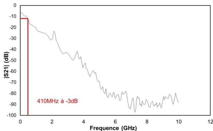
Figure 4—79 : Bande Passante du Laser accordable
