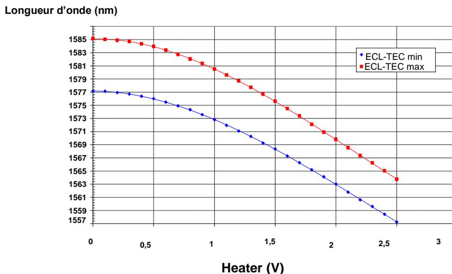
Figure 4—84 : Longueurs d'onde d'émission du laser accordable T-ECL en fonction de la tension appliquée au Bragg (heater)
