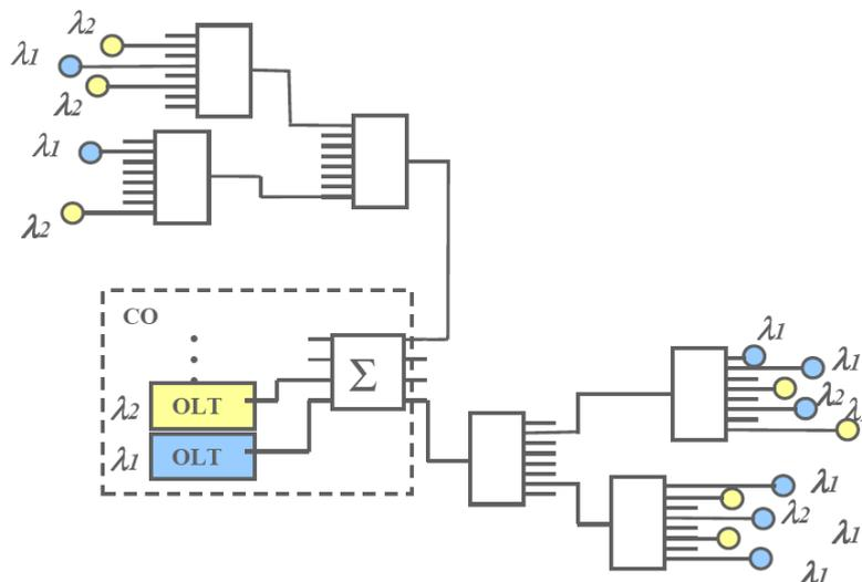
Figure 2—31 : Schéma de déploiement PON proposé, sens descendant
