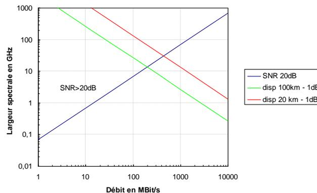
**Figure4: Représentation des limites du spectrum slicing en fonction du débit et de la largeur spectrale du signal. La zone est délimitée en bas par le SNR de 20 dB et en haut par les limites de dispersion pour des distances de transmission de 20 et 100 km avec une pénalité maximum de 1dB.**
