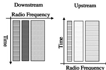
Figure 2—10 : Principe du FDM
