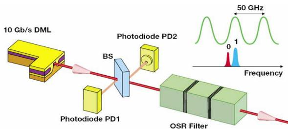
Figure 4—76: Principe du laser à gestion de chirp (CML)
