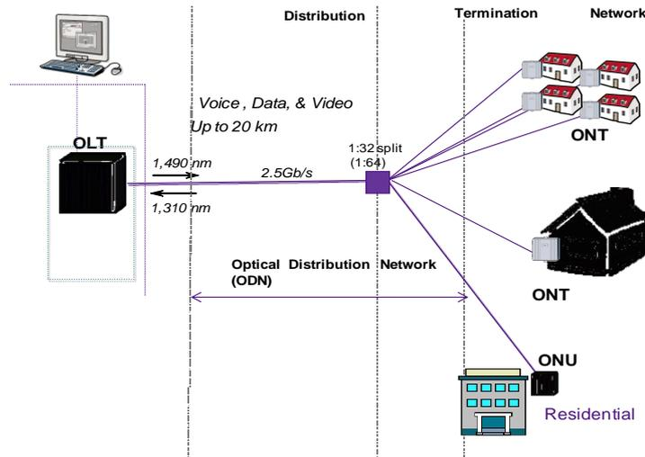
Figure 1—3 : Diagramme schématique du réseau GPON
