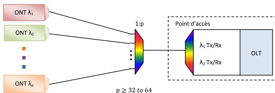
Figure 2—6 : Exemple de PON avec un ODN utilisant un répartiteur en longueur d'ondes
