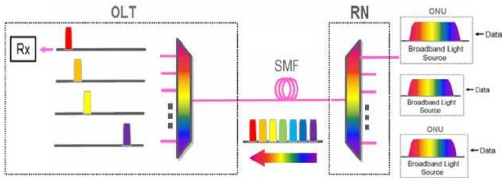
Figure 3—12 : Principe de fonctionnement d'une source large bande à modulation directe et à découpage spectral dans un système WDM-PON (Source LG-Nortel)
