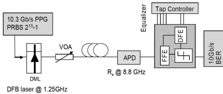
Figure 4—25 : Montage expérimental : laser DFB à faible bande passante assisté par un égaliseur électronique (EDC)
