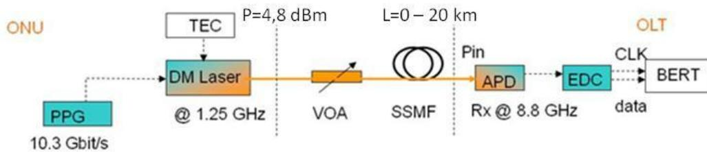
Figure 4—34 : Montage expérimental avec un laser DML à 1GHz et intégrant l'égaliseur (ou EDC) visant à étudier le non-refroidissement du laser
