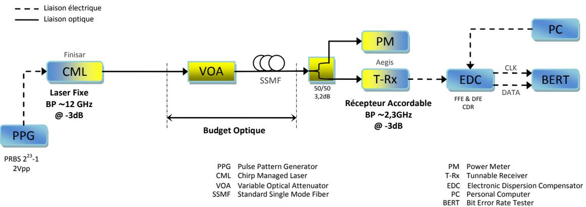
Figure 4—93 : Montage expérimental de la solution PON Agile intégrant un CML (à l'OLT) et un T-Rx (à l'ONU) assisté par égaliseur
