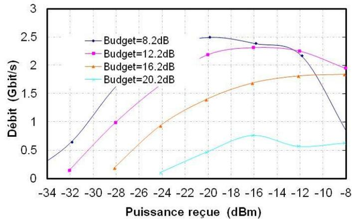
Figure 4—66 : Débit vs Puissance reçue pour différents budgets optiques (L=0 km)
