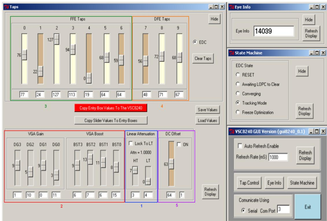
Figure 4—29 : Interface logicielle de contrôle du module EDC 8240-01
