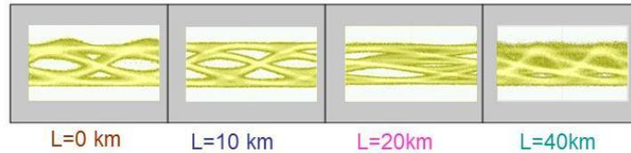
On s'aperçoit qu'au-delà de 20 km, l'œil est complètement fermé sans l'intervention de l'égaliseur électrique. Pourtant, en se référant aux mesures de BER exposées à la Figure 4-32 ci-dessous, après insertion de l'égaliseur ou EDC, dans les mêmes conditions de température, une bonne transmission à 20 km est atteinte, avec un budget optique de 26 dB environ pour un BER de  $10^{-3}$ .
