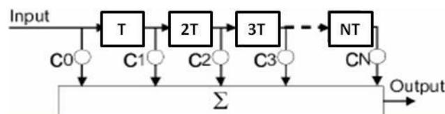
Figure 2—24 : Principe d'un FFE
