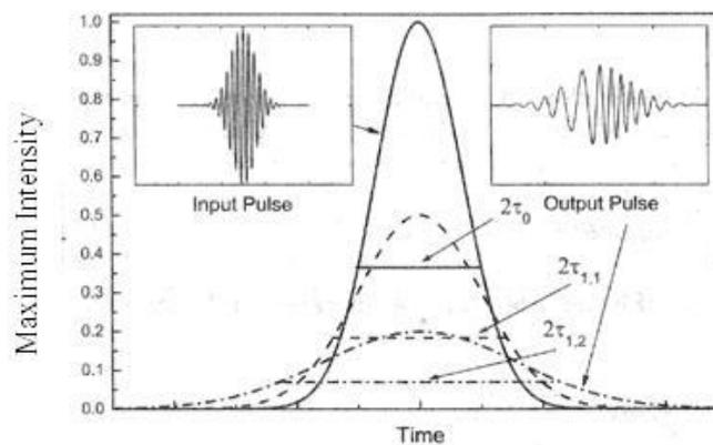
Figure 2—22 : Elargissement temporel d'une impulsion d'enveloppe gaussienne après propagation dans une fibre [Sc10]
