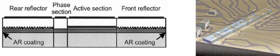
Figure 3—19 : Laser accordable SSG-DBR (1,25 Gbit/s) [76] (a) et intégration monolithique d'un DS-DBR avec un modulateur pour l'application XFP accordable (10 Gbit/s) destinée au réseau métro-accès (Source : Oclaro [Ca28]) (b)
