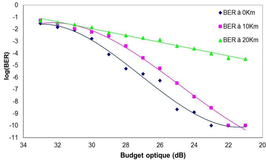
Figure 4—88 : BER à 10 Gbit/s en fonction du Budget optique
