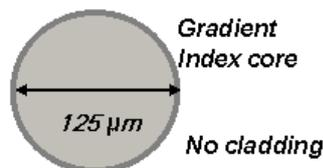
Figure 4—8 : Une fibre multimode à gradient d'indice
