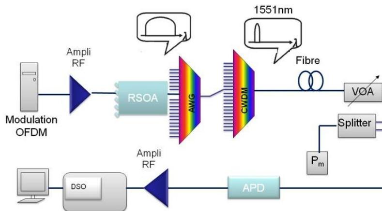
Figure 4—50 : Montage expérimental d'un WDM PON simplifié utilisant un RSOA comme source large bande
