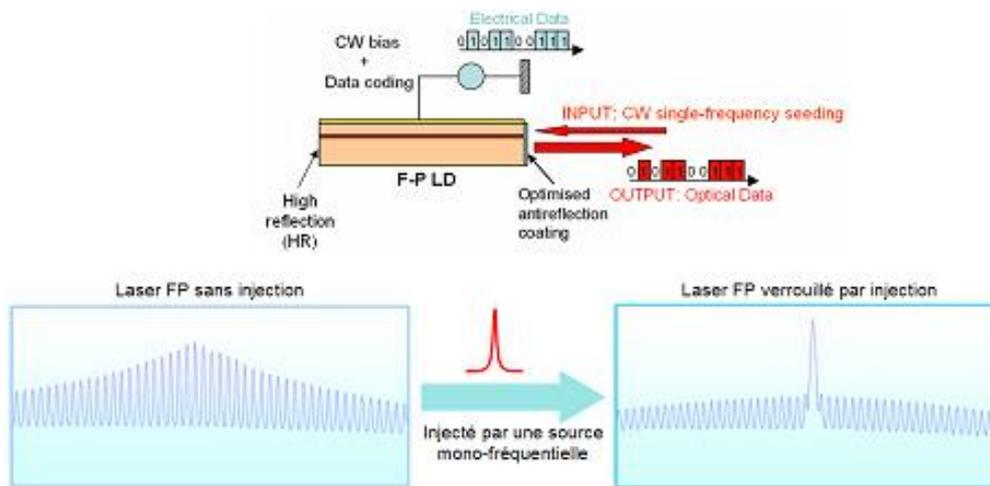
Figure 3—27 : Principe de fonctionnement d'un laser Fabry-Perot verrouillé par injection optique et exemple de spectre optique
