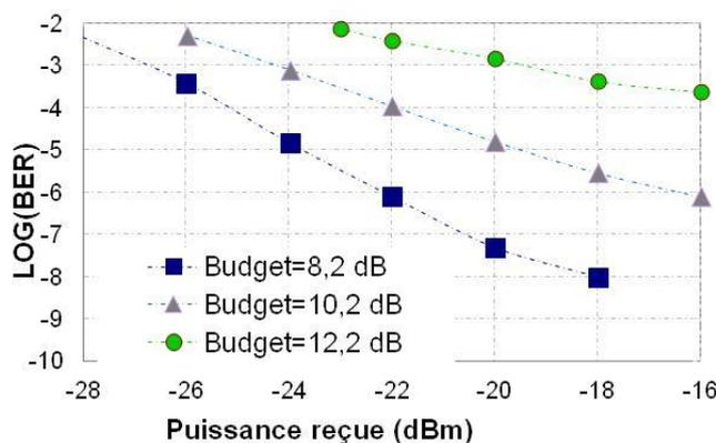
Figure 4—63 : BER vs Puissance reçue en fonction du budget optique à 1,25 Gbit/s (L=20 km)
