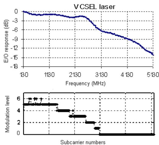
Figure 2—18 : Cartographie de la constellation M-QAM adaptative par sous-porteuse selon la réponse fréquentielle du lien de transmission optique
