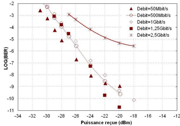
Figure 4—61 : BER vs Puissance reçue en fonction du débit pour un budget optique de 12,2 dB ( L=0 km)
