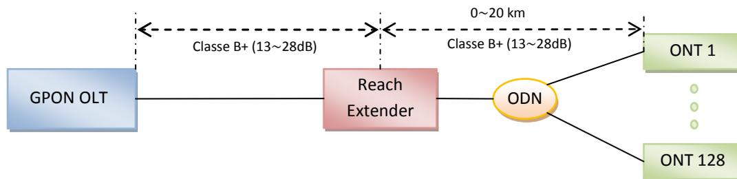
Figure 1—8 : Principe du GPON à longue portée intégrant un « Reach Extender »
