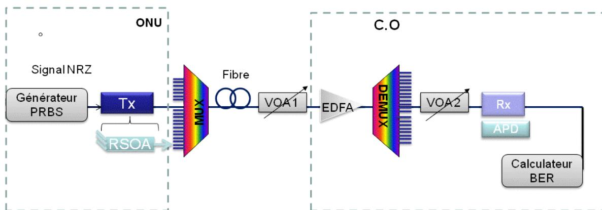
Figure 4—59 : Principe du montage expérimental pur WDM PON : avec un RSOA modulé par un signal NRZ
