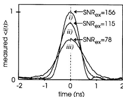
Figure1 : Elargissement de l'impulsion et de la diminution simultanée du SNR dus à la dispersion chromatique dans une transmission effectuée en spectrum slicing [Gr].
