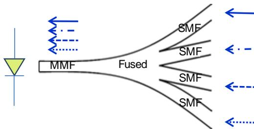
Figure 5—1 : Solution basée sur la fusion de fibre multimode et fibres monomodes
