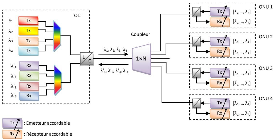
Figure 2—29: Architecture du PON "Agile" en longueur d'onde
