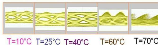
L'œil est ouvert jusqu'à 40°C si l'architecture n'implémente pas d'égaliseur électronique. Au-delà de cette température, le signal se dégrade. A 70°C, par exemple, le signal est complètement altéré. Ensuite, on s'intéresse à l'impact de l'utilisation de l'égaliseur électronique dans la Figure 4-35.
