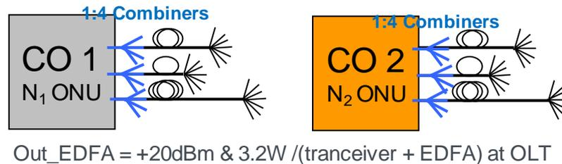
Figure 4—22 : Scénario de consolidation avec un transpondeur B+, le nouveau combineur 4 :1 et un EDFA
