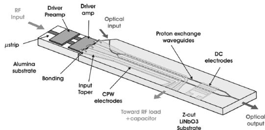
Figure 3—8 : Modulateur interférométrique
