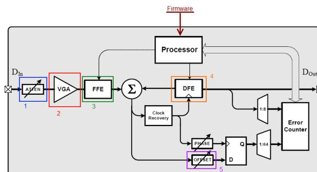
Figure 4—28: Schéma bloc du traitement des données dans le module EDC 8240-01
