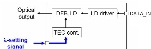
Figure 3—18 : Un exemple d'un laser DFB accordable en longueur d'onde par l'ajustement de la température (Source : NTT [[Su26](#)])
