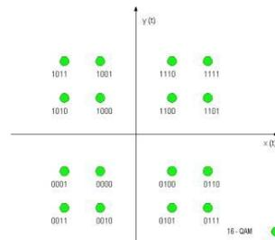
Figure 2—12 : Constellation de modulation 16 QAM ; modulation sur 4 niveau (L=4)
