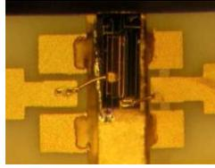
Figure 3—7 : Laser avec modulateur externe (EML)
