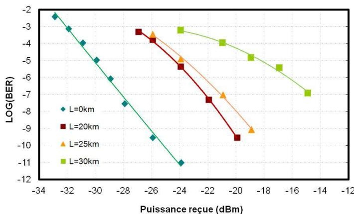
Figure 4—64 : BER en fonction de la longueur de la fibre lorsque le débit est fixé à 1,25Gbit/s et budget optique à 8,2 dB
