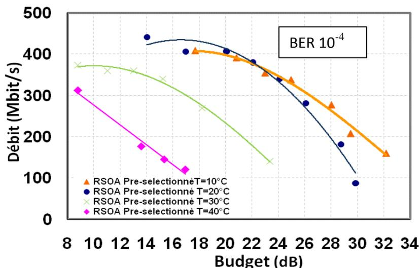
Figure 4—57 : Débit vs Budget pour un RSOA présélectionné à différentes températures
