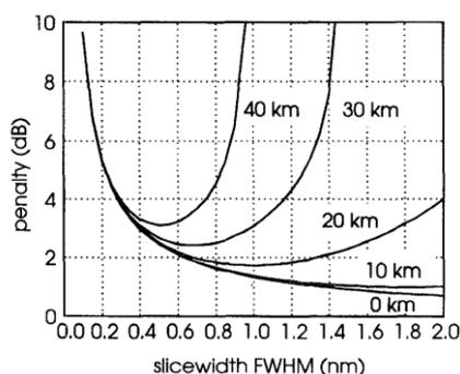
Figure 2 : Pénalités en puissance requises pour maintenir un BER de 10<sup>-9</sup> en fonction de la largeur spectrale du signal pour une transmission à 1,25Gbit/s sur 0, 10, 20, 30 et 40 km de SMF. Le spectre optique du signal est gaussien et centré à 1550nm [Gr].
