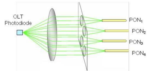
Figure 5—2 : Solution basée sur des optiques en espace libre
