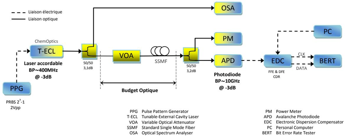
Figure 4—78 : Montage expérimental du PON Agile intégrant un T-ECL (à l'ONT) et une APD assisté par EDC (à l'OLT)
