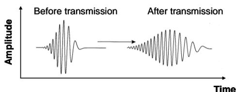
Figure 3—4 : Chirp d'une impulsion gaussienne
