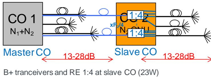
Figure 4—23 : Scénario de consolidation avec un transpondeur B+ et un RE 1 vers 4
