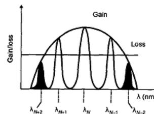
Figure 3—17: Courbe gain-sur-pertes et modes longitudinaux possibles dans un laser FP
