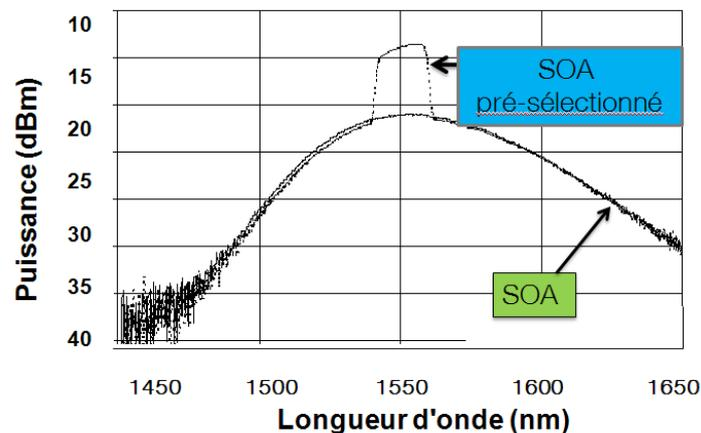
Figure 4—56 : Spectre de RSOA avec et sans présélection
