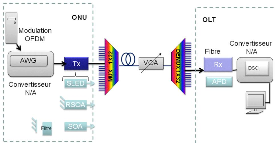
Figure 4—39 : Principe de base de l'architecture pur WDM PON étudiée avec des sources ASE (RSOA ou SLED ou RSOA présélectionné) pour la réalisation d'ONU achromatique (liaison montante)
