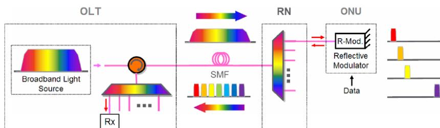
Figure 3—25: Porteuses optiques incohérentes en utilisant une source large bande à découpage spectral
