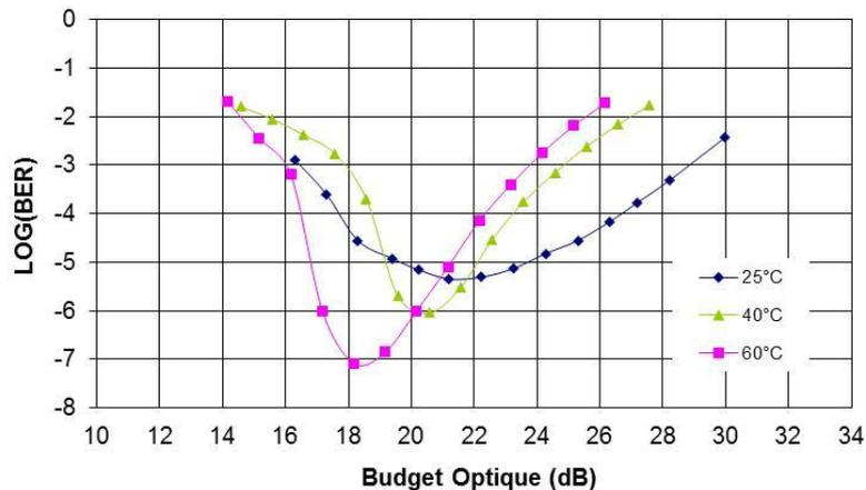
Figure 4—36 : Courbes de BER vs. Budget pour différentes températures (L=20km et EDC implémenté)
