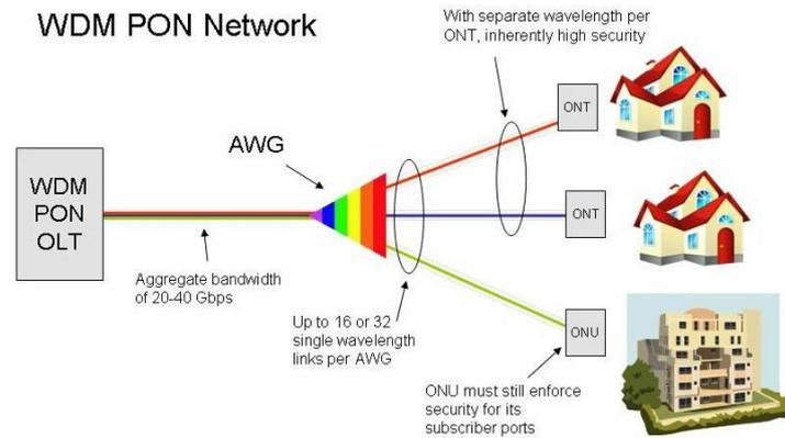
Figure 2—7: Exemple de NG-PON utilisant un AWG
