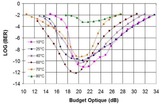
Figure 4—35 : Courbe de BER vs. Budget en fonction de la Température (L=0 km et EDC implémenté)
