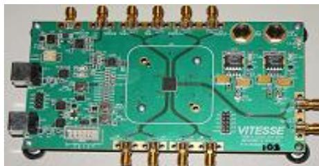
Figure 4—27 : Platine d'évaluation de l'EDC
