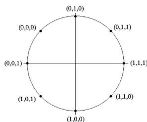
Figure 2—11 : constellation de modulation 8-PSK
