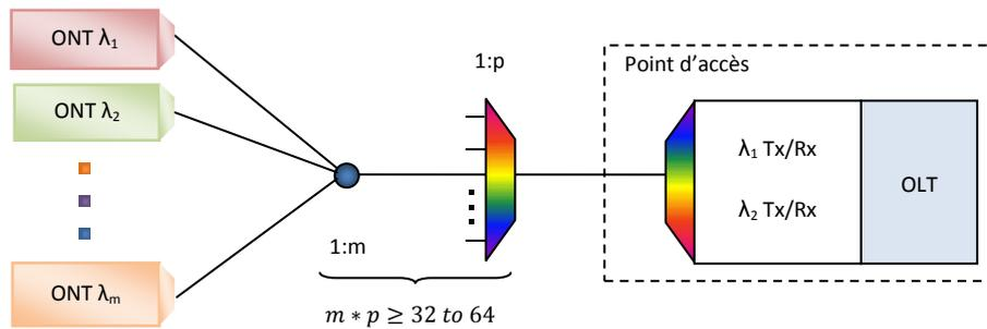
Figure 2—8 : Exemple de WDM hybride avec un diviseur de puissance dans l'ODN pour la NG-PON2
