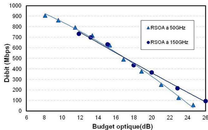
Figure 4—54 : Débit vs. Budget avec une largeur de découpage spectral de 50 et 150 GHz
