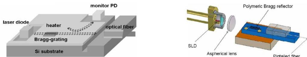
Figure 3—23 : Exemple d'une structure ECL accordable à base d'un réseau de Bragg en polymère contrôlé en température et la mise en module (Source : ETRI)
