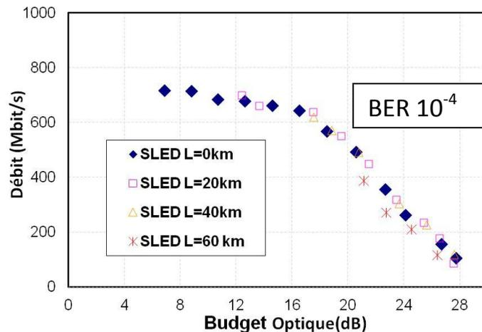
Figure 4—42 : Débit vs. Budget pour différentes longueurs de fibres (L=[0 :60km])
