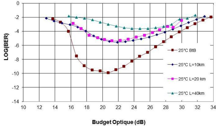
Figure 4—31 : Courbe de BER vs. Budget pour différentes longueurs de fibre (T=25°C et avec égaliseur)
