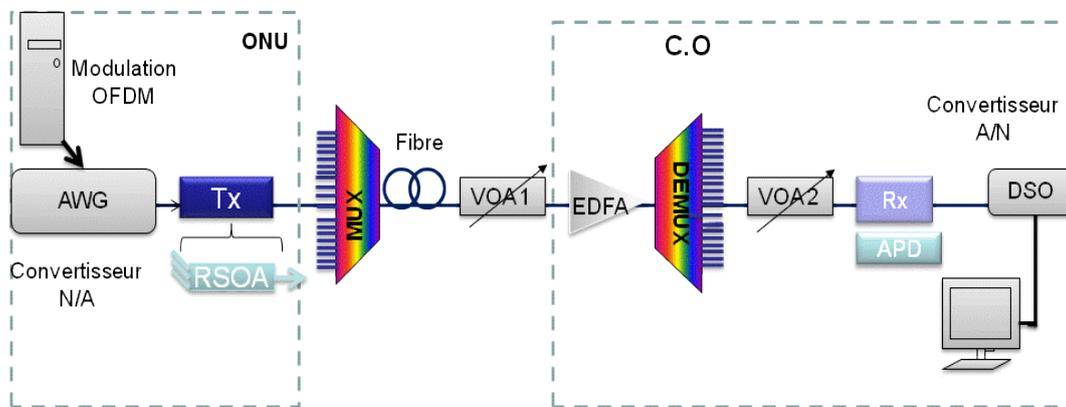
Figure 4—65 : Principe du montage expérimental d'un PON hybride : avec RSOA modulé par un signal OFDM
