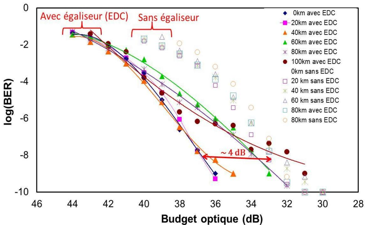
Figure 4—85 : BER à 1.25 Gbit/s en fonction du Budget optique
