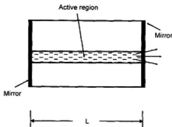
Figure 3—16: Laser Fabry Pérot (FP) avec miroirs plans
