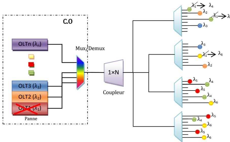
Figure 2—33: PON agile en longueur d'onde avec réarrangement des longueurs d'ondes en cas de panne
