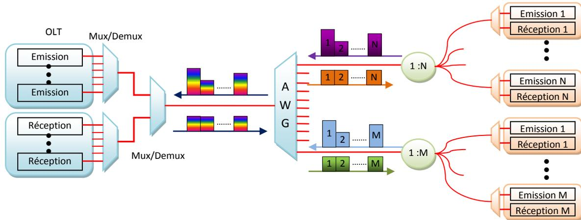
Figure 2—9: Principe de l'architecture WDM-TDMA PON dans le sens montant
