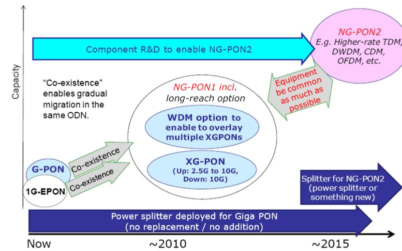
Figure 1—9 : Planification de l'évolution du NGPON au FSAN(Ef7)
