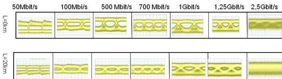
L'étude des diagrammes de l'œil montre que le signal reçu à travers l'architecture WDM PON intégrant un RSOA tranché spectralement et modulé directement en format NRZ est acceptable jusqu'à 1,25 Gbit/s avec ou sans fibre. Aucun composant de compensation ou d'égalisation n'a été inséré dans le système. Cependant, à partir de 2,5 GHz, l'œil est complètement fermé. On note que l'insertion de la fibre dégrade légèrement le signal à la réception en raison de la dispersion chromatique.
