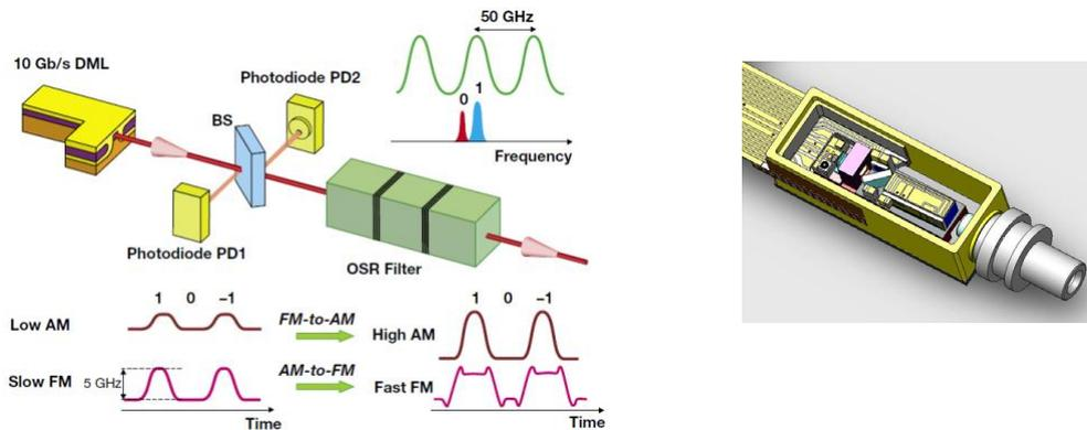
Figure 3—6 : Laser à gestion de chirp (CML)
