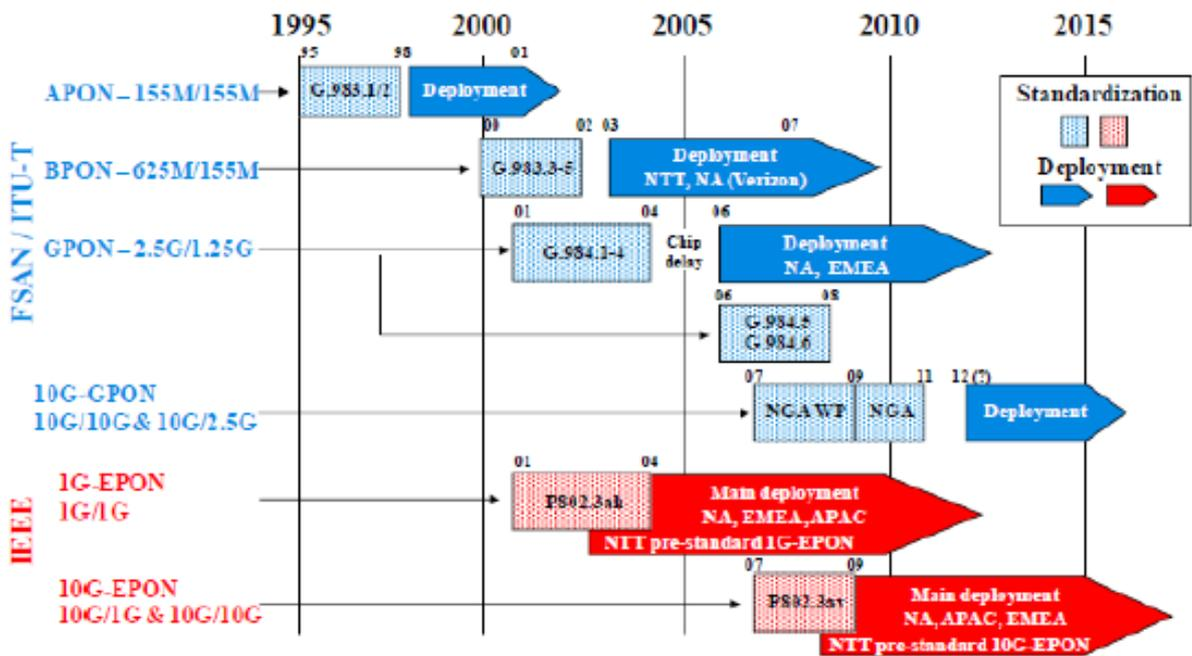
Figure 1—6 : Systèmes IEEE et FSAN/ITU-T PON et leur état de standardisation dans le temps
