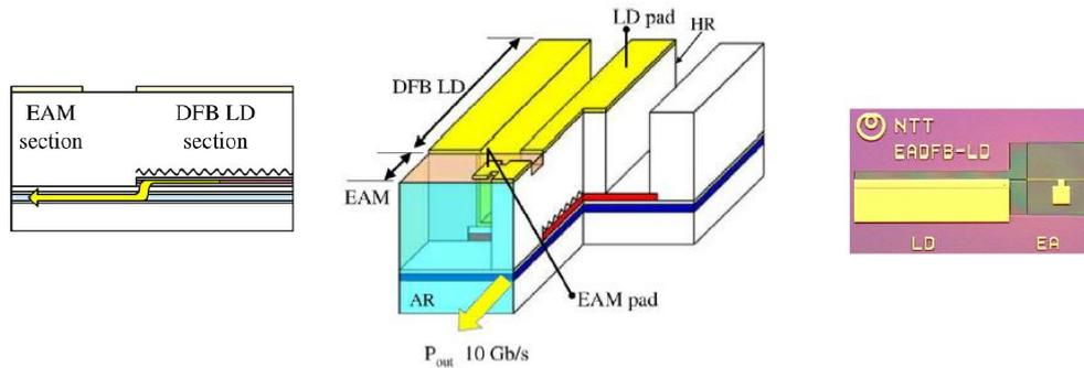
Figure 3—9 : Exemple de structure d'un EML (Source NTT [Ko10])
