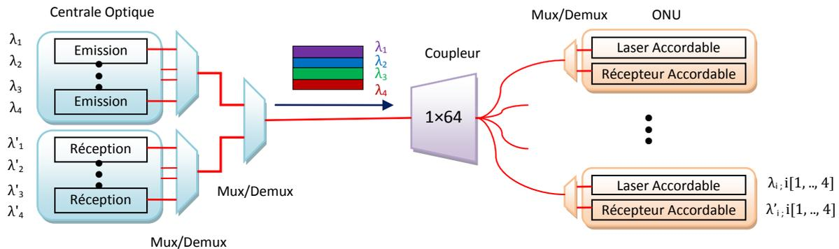
Figure 2—30 : Architecture du PON "agile" en longueurs d'onde avec un débit 4 fois supérieur
