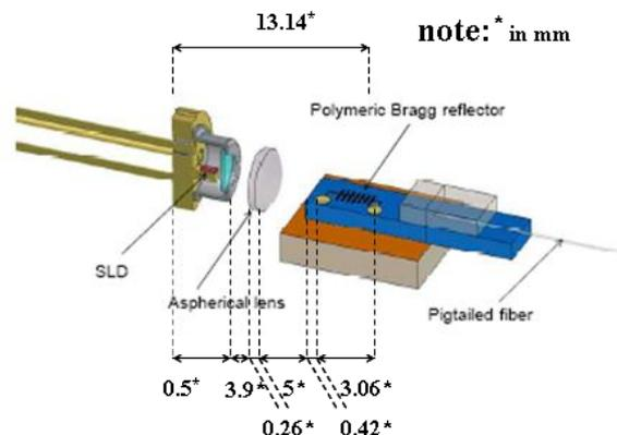
Figure 4—71 : Diagramme schématisé de laser accordable intégré hybride constitué par une SLED, une microlentille asphérique, et un réflecteur de Bragg polymérique accordable .
