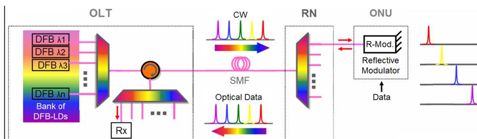
Figure 3—26: Porteuses optiques cohérentes en utilisant un ensemble de diodes lasers DFB
