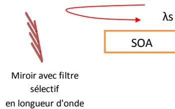
Figure 4—55 : Principe du RSOA présélectionné avec un miroir chromatique
