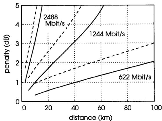
Figure 3 : Pénalité en puissance minimum qui peut être en fonction de la distance de transmission à des débits de 622, 1244 et 2488 Mbit/s pour des taux d'extinctions infini (traits pleins) et 1/15 (traits pointillés) avec une forme gaussienne.
