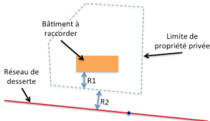
Le schéma ci-dessus indique les deux grandeurs permettant d'identifier les coûts de raccordement d'un bâtiment :
