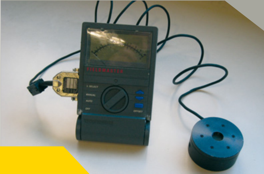
FIGURE 13 APPAREIL DE MESURE DE LA PUISSANCE DU LASER: la puissance réduite du rayonnement laser est convertie en puissance thermique puis en signal électrique.
