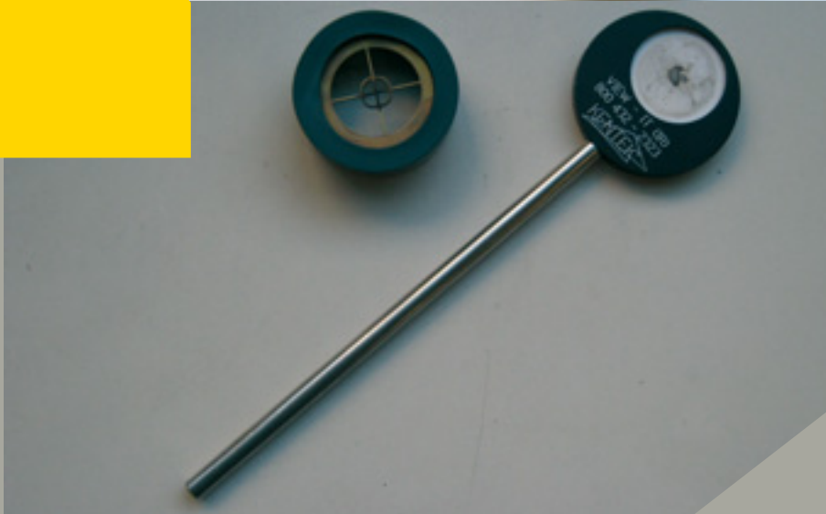
FIGURE 14 MIRE POUR L'ALIGNEMENT OPTIQUE. Cette mire est placée sur le chemin optique en un endroit prévu pour l'alignement. L'ombre de la croix doit apparaître au centre de la cible phosphorescente.
