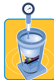
Mesure du DAS (débit d'absorption spécifique) d'un téléphone mobile.
