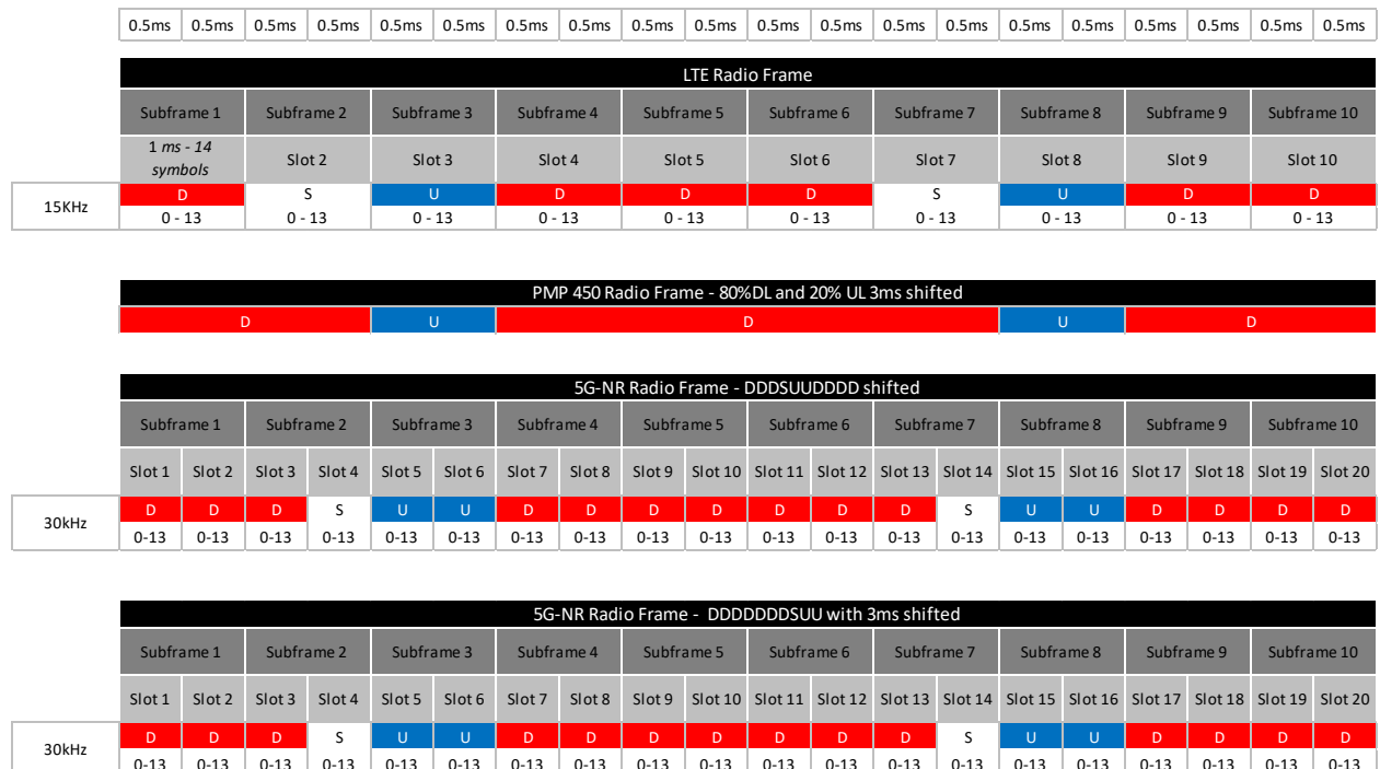
Figure 3.- Schéma de synchronisation TDD pour la coexistence LTE, PMP 450 et 5G-NR. (D est une sous-trame pour la transmission en liaison descendante, S est une sous-trame "spéciale" utilisée comment un temps de garde, U est une sous-trame pour la transmission en liaison montante)
