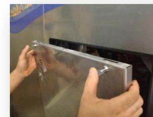
En tournant deux petites molettes, ouvrir simultanément la porte latérale de la machine pour accéder à la trappe. Ensuite, posez-la sur le sol en position verticale.
