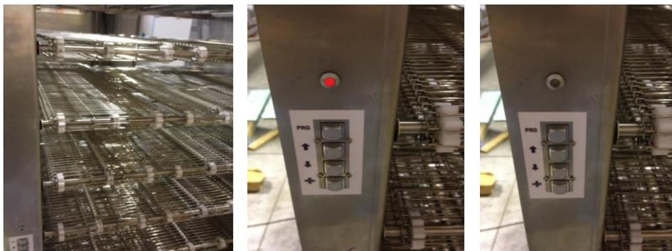
**1)** Appuyez sur le bouton PRG pendant 1 seconde, un voyant rouge s'allume (petit bouton rond se trouvant à droite à l'arrière de la machine au dessus des touches d'avancement et de recul des tapis : Mode de Chargement Manuel).
