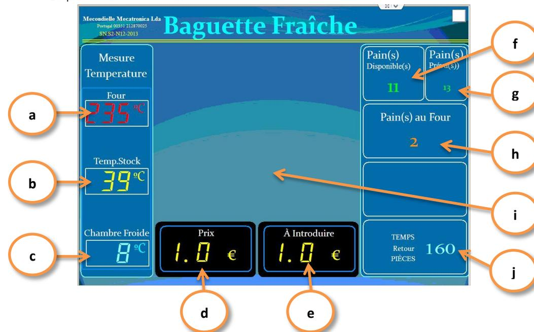
**a.** Il indique la température à laquelle le four cuit le pain. Cette température est paramétrée par le fabricant. Si il convient d'adapter cette température, consultez la section "PARAMETRES, température du four" p. 30.
