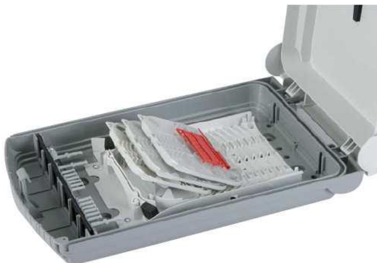
Figure 9 : boîtier 3M pour 72 soudures maximum dans 6 cassettes de 12 soudures
