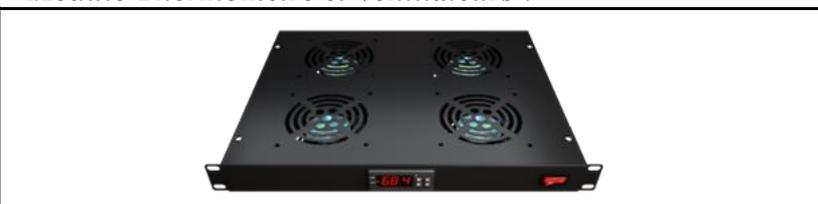
Cet élément "actif" de la baie est composé d'un bloc d'alimentation, d'un affichage LCD et d'un capteur de température. Il y a aussi deux ou quatre ventilateurs, ils servent à extraire l'air chaud de la baie. Ce genre de matériel est souvent installé dans des baies avec des serveurs.
