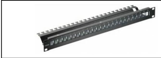
Ce genre de module fait en général 1U de hauteur et permet d'accueillir 24 modules Keystone, ce genre de modules permet par exemple de mettre aussi bien des corps de traverses fibre ou des prises HDMI ou bien dans notre cas des noyaux RJ45. Il y en a de toutes les sortes mais je conseille tout de même de choisir un panneau avec au dos la possibilité de serrer les câbles au panneau avec des colliers de serrage pour pérenniser l'installation.
