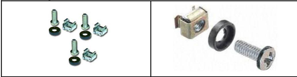
Ce genre d'écrous se mettent sur le rail vertical percé de la baie, puis on y met le module et on le visse, c'est un élément indispensable d'une baie. Il existe plusieurs types de kit d'écrous cage / vis avec des vis cruciformes ou bien Allen (6 pans creux) permettant une couple de serrage de la vis beaucoup plus important sans trop forcer.
